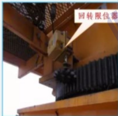
回转限位缺少带动啮合小齿轮
