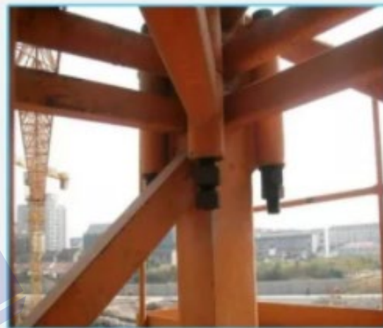
标准节连接螺栓松动
